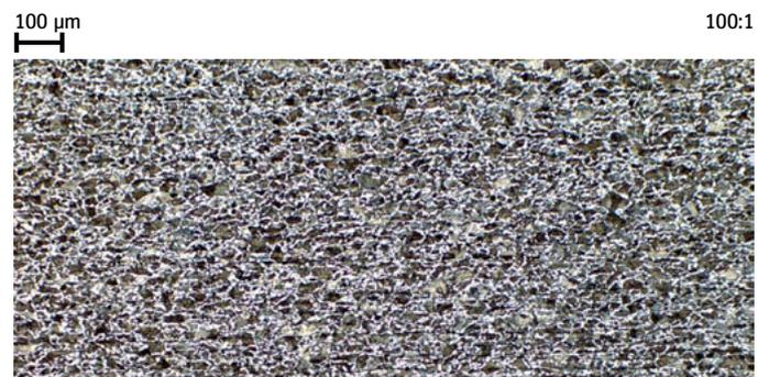
Mikrostruktur aus Ferrit und Perlit.
